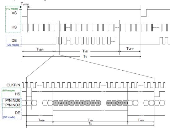
Note:  $T_V=T_{VBP}+T_{VD}+T_{VFP}$  $T_H=T_{HBP}+T_{HD}+T_{HFP}$
